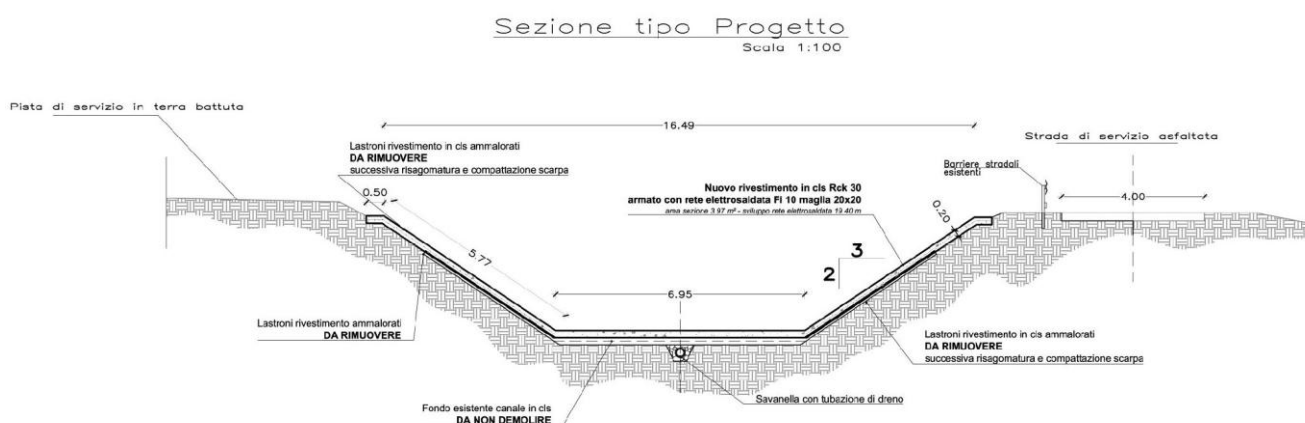
Figura 21 Sezione di progetto del canale a sezione trapezia che necessita di manutenzione
